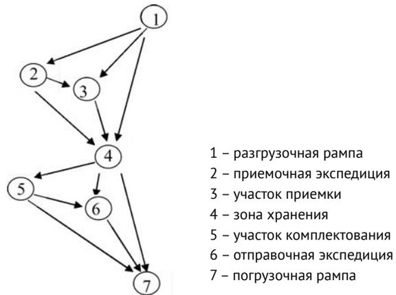
Рисунок 1 – Схема движения грузопотока на складе
