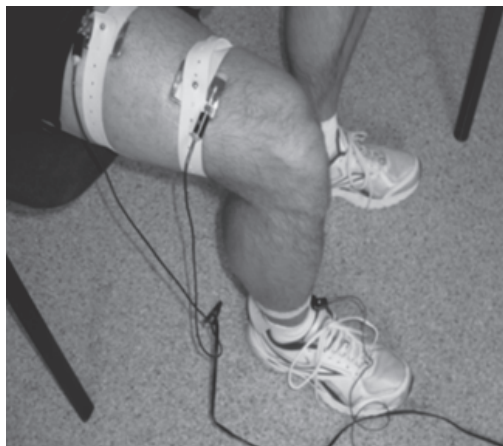
Рис. 1. Расположение электродов на теле испытуемого при регистрации ЛВН и ЛВР
